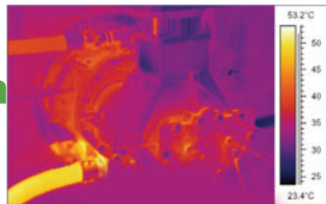
Begrenzter Temperaturanstieg von nur 25 °C im Kompressorelement
